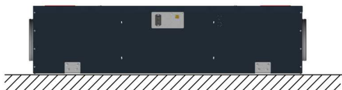
Slika 17: Namestitev naprave v ležeči položaj
