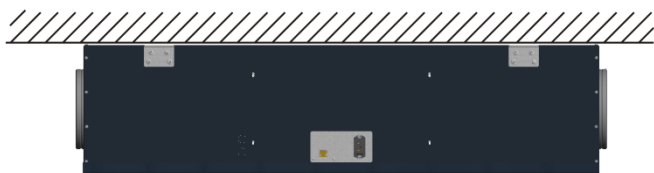
Slika 16: Namestitev naprave na strop
