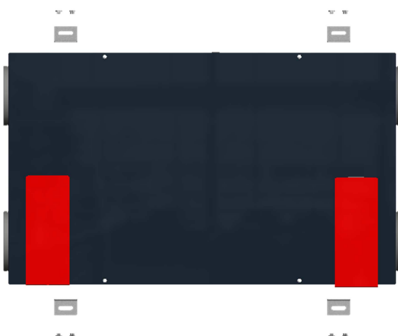
Slika 15: Lokacija pritrdilnih elementov
