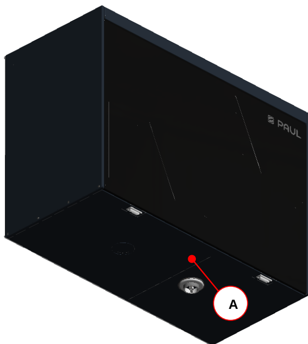
Slika 18: 1¼-colski navojni priključek za suhi sifon na levo.
